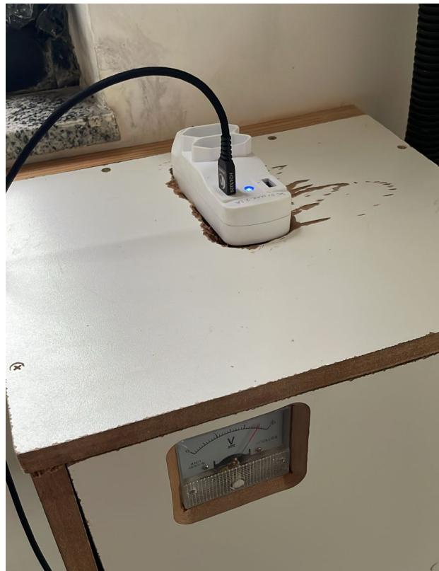
Figura D. Saídas do Sistema Off-grid microaerogerador DEL
