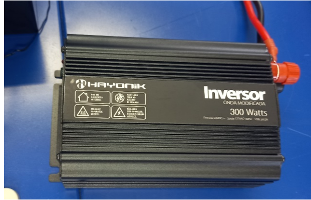
Figura C. Inversor Off-grid do sistema de microaerogerador do DEL.
